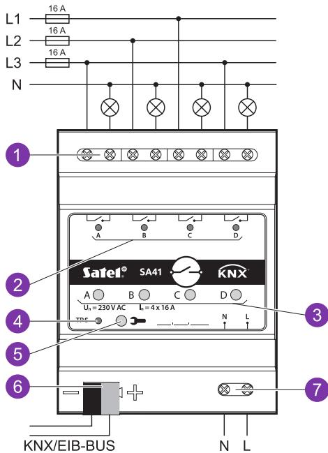
1. morsetti del circuito di carico per il collegamento dei carichi (2 morsetti per canale).
