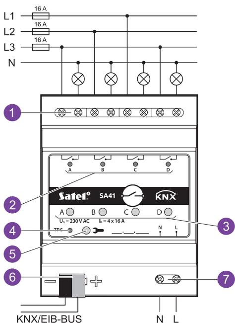
1. Клеммы цепи нагрузки для подключения нагрузки (по 2 клеммы на канал).
